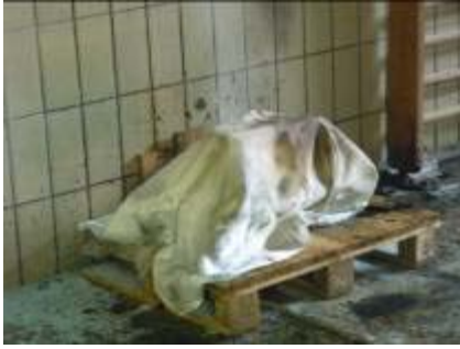
Unterschiedliche Löschmittel – unterschiedliche Auswirkungen auf den Entstehungsbrand und das Archivgut: Löschdecke und Schaumlöcher
