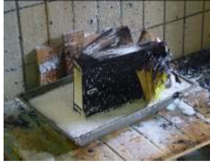
Unterschiedliche Löschmittel – unterschiedliche Auswirkungen auf den Entstehungsbrand und das Archivgut: Löschdecke und Schaumlöcher
